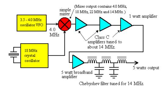
20 Meter 5 Watt QRP Transmitter Block Diagram
